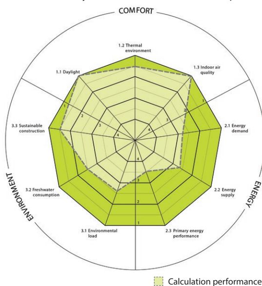
Рис. 5. Радар Active House, показывающий производительность здания на основе расчетных данных [3]
