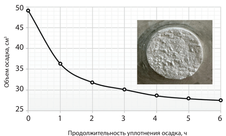
Рис. 4. Уменьшение объема осадка в процессе уплотнения (график составлен автором)
