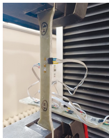
Рис. 6. Испытание образца № 1 на осевое растяжение (фото автора)
