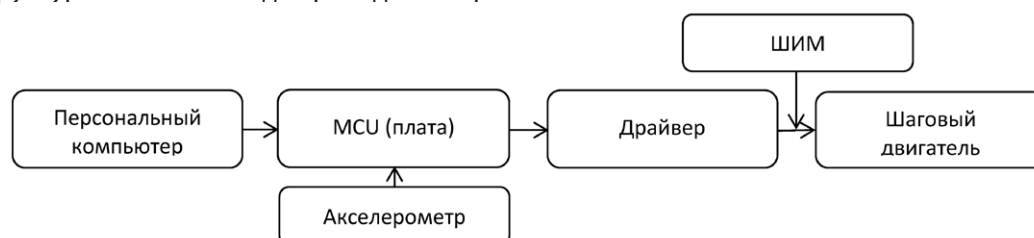
Рис. 1. Структурная схема экспериментального стенда (составлена авторами)
