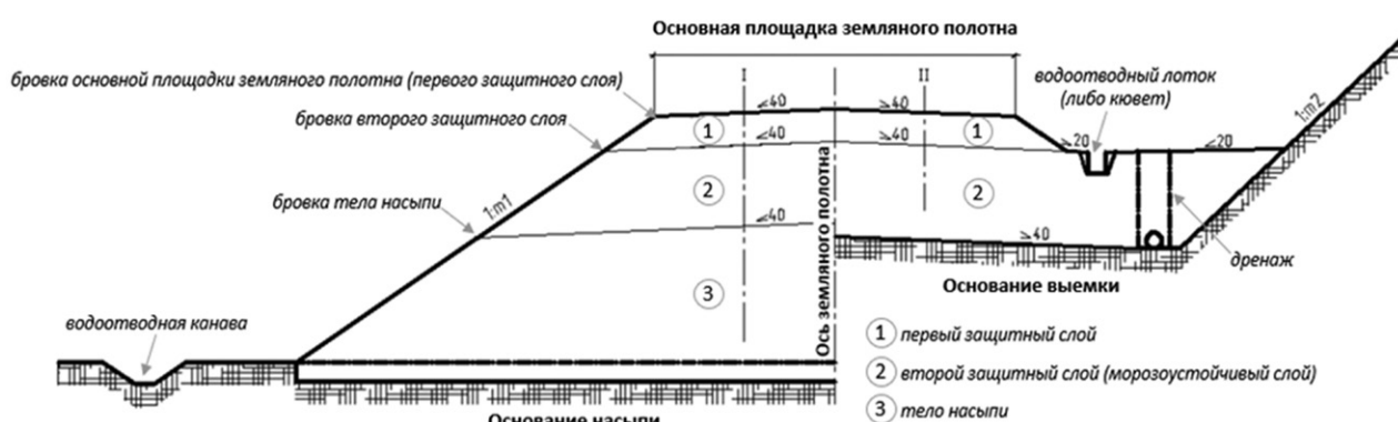
Рис. 1. Основные элементы земляного полотна ВСМ [3]
