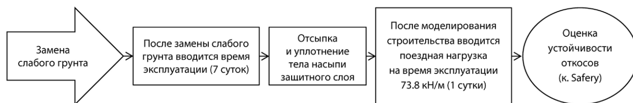
Рис. 6. Численное моделирование расчета этапов (схема составлена авторами)
