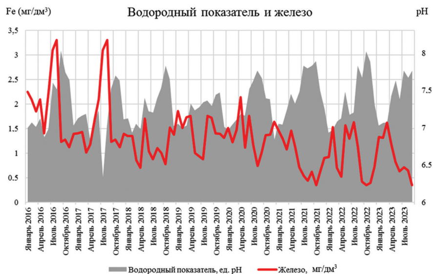
Рис. 4. Изменение содержания железа и водородного показателя по сезонам года в течение семилетнего наблюдения Fig. 4. Change in iron content and hydrogen index by seasons during a seven-year observation period
