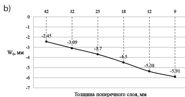
Рис. 3. Зависимость максимального прогиба от толщины поперечного слоя: а) жесткое защемление на обеих опорах; б) шарнирное опирание на обеих опорах; в) жесткое защемление с шарниром
