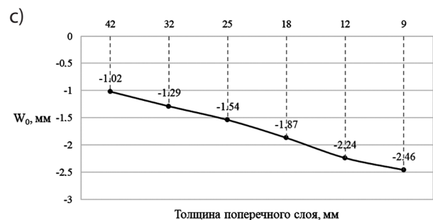
Рис. 3. Зависимость максимального прогиба от толщины поперечного слоя: а) жесткое защемление на обеих опорах; б) шарнирное опирание на обеих опорах; в) жесткое защемление с шарниром
