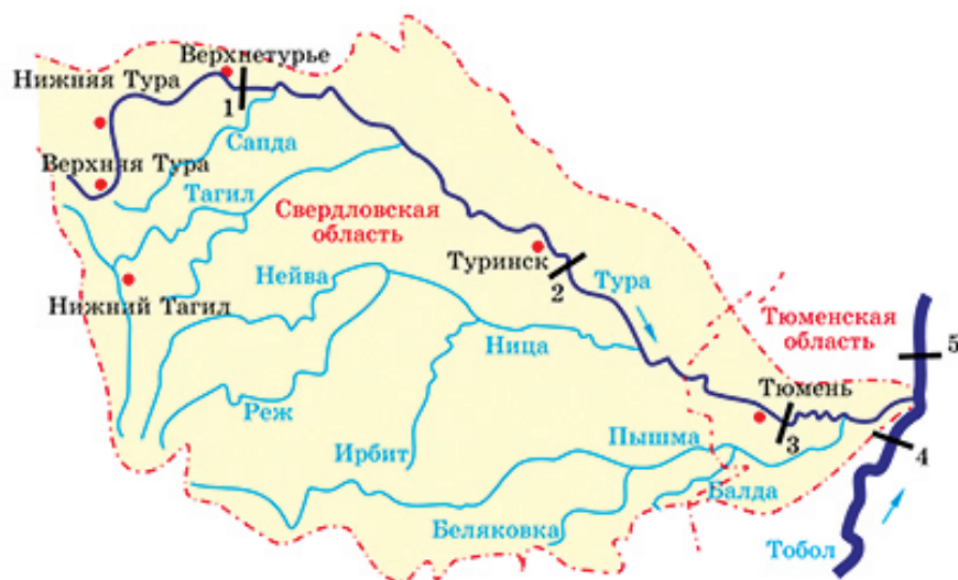
Рис. 2. Схема бассейна р. Туры с расчетными створами [9] Fig. 2. Scheme of the Tura basin with the control stations [9]
