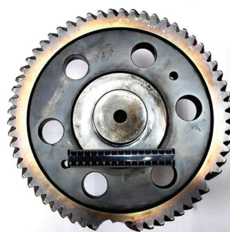
Рис. 4. Внешний вид шестерни 2 с повреждениями Fig. 4. Appearance of gear 2 with damages
