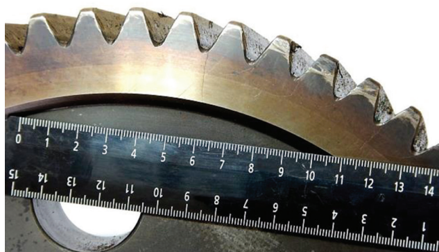
Рис. 6. Радиальные трещины в основании зубьев шестерни 2
