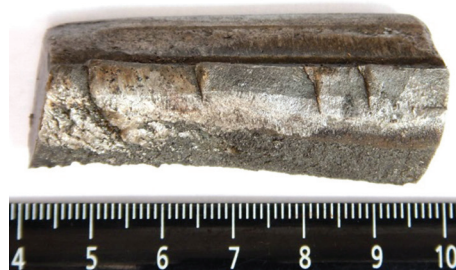
Рис. 2. Поверхность повреждения зуба шестерни 2 (сторона нагружения) Fig. 2. Damage surface of the tooth of gear 2 (load side)
