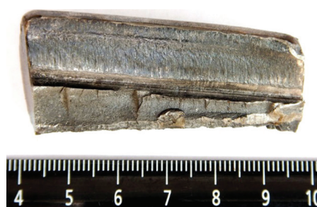
Рис. 3. Поверхность повреждения зуба шестерни 2 Fig. 3. Damage surface of the tooth of gear 2
