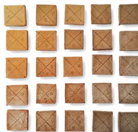
Рис. 1. Огневая усадка керамического черепка
