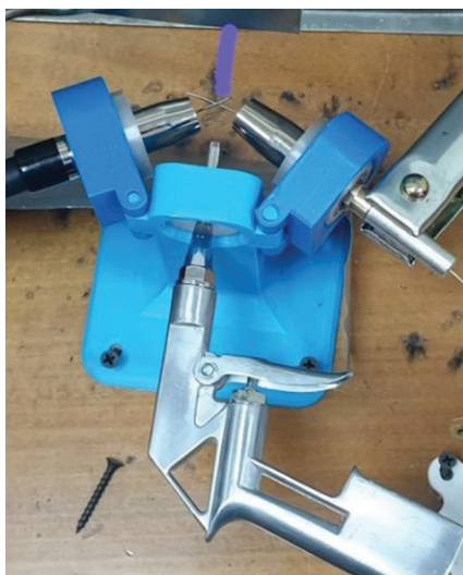
Рис. 1. Экспериментальный стенд для воссоздания процесса холодного напыления:
