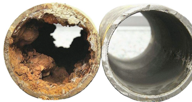
Рис. 1. Фрагменты внутренних отложений на водопроводных (а), канализационных (б), тепловых (с) сетях
