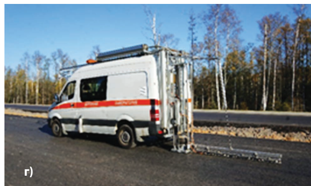
Рис. 1. Оборудование для оценки прочности дорожных одежд автомобильных дорог: а) длиннорычажный прогибомер; б) установка динамического нагружения «Дина-4»; в) установка «ДИП Импульс»; г) универсальный диагностический комплекс типа «УДК»
