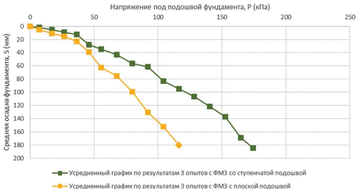
Рис. 6. Результаты лабораторного эксперимента моделирования работы столбчатых фундаментов со ступенчатой и плоской подошвами
