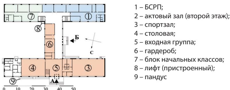
Рис. 6. Предлагаемые объемно-планировочные решения по модернизации БСРП (схема составлена авторами)
