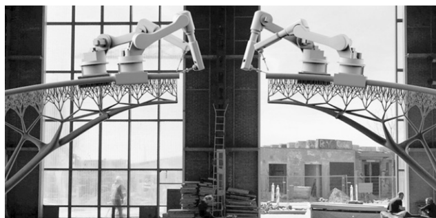
Рис. 2. Создание сварочной мостовой конструкции, Амстердам (Голландия) 2 Fig. 2. Fabrication of a welded bridge structure, Amsterdam (Holland) 2
