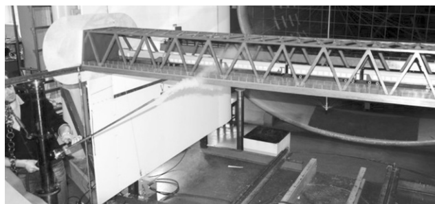
Рис. 3. Испытания модели Крымского моста в аэродинамической трубе 3 Fig. 3. Aerodynamic testing of a Crimean Bridge model in a wind tunnel 3
