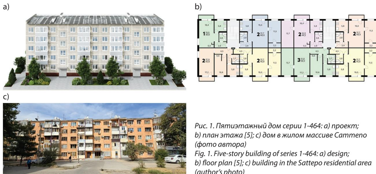
Рис. 1. Пятиэтажный дом серии 1-464: а) проект; б) план этажа [5]; в) дом в жилом массиве Саттепо (фото автора)
