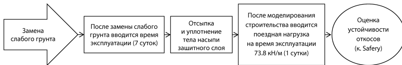
Рис. 6. Численное моделирование расчета этапов (схема составлена авторами) Fig. 6. Numerical modeling of calculation stages (diagram created by the authors)
