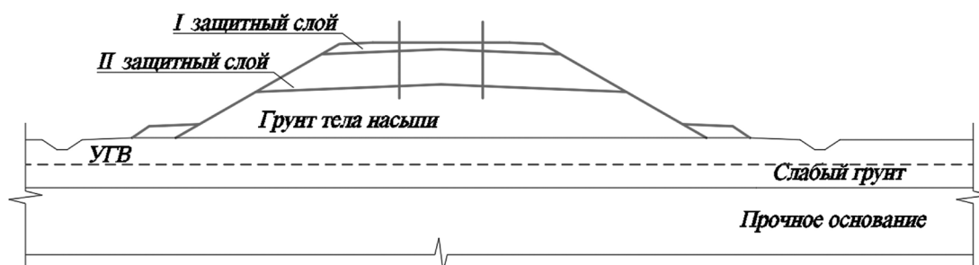
Рис. 4. Типовая конструкция замены слабого грунта (схема составлена авторами в AutoCAD)
