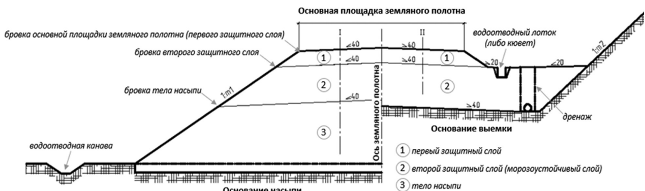
Рис. 1. Основные элементы земляного полотна ВСМ [3]
