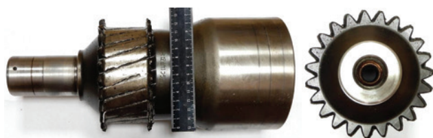
Рис. 1. Внешний вид шестерни 1 с повреждениями Fig. 1. Appearance of gear 1 with damages
