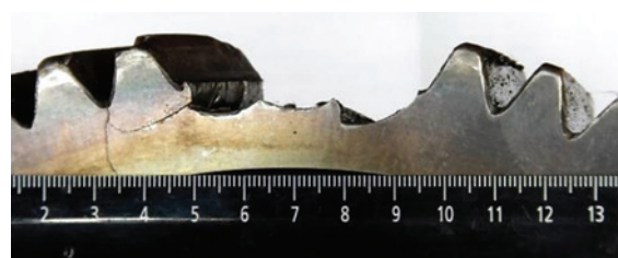
Рис. 5. Излом зубьев шестерни 2 Fig. 5. Teeth failure of gear 2
