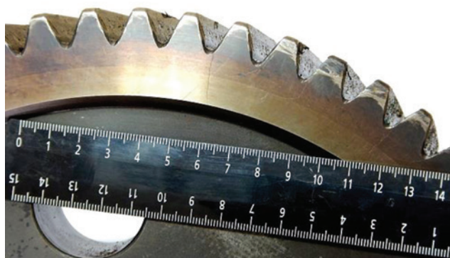
Рис. 6. Радиальные трещины в основании зубьев шестерни 2
