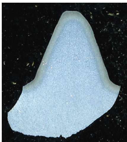
Рис. 12. Схема измерения твердости на зубе: шестерня 1 – шаг измерения 0.15 мм; шестерня 2 – шаг измерения 0.2 мм Fig. 12. Tooth hardness measurement scheme: measurement step 0.15 mm for gear 1; measurement step 0.2 mm for gear 2
