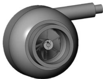
Рис. 2. Упрощенная модель улитки Fig. 2. Simplified scroll model
