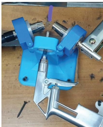
Рис. 1. Экспериментальный стенд для воссоздания процесса холодного напыления:
