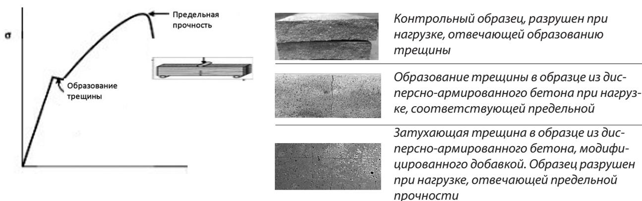
Рис. 8. Схема испытания образцов и регистрируемые параметры при испытании (составлена авторами)
