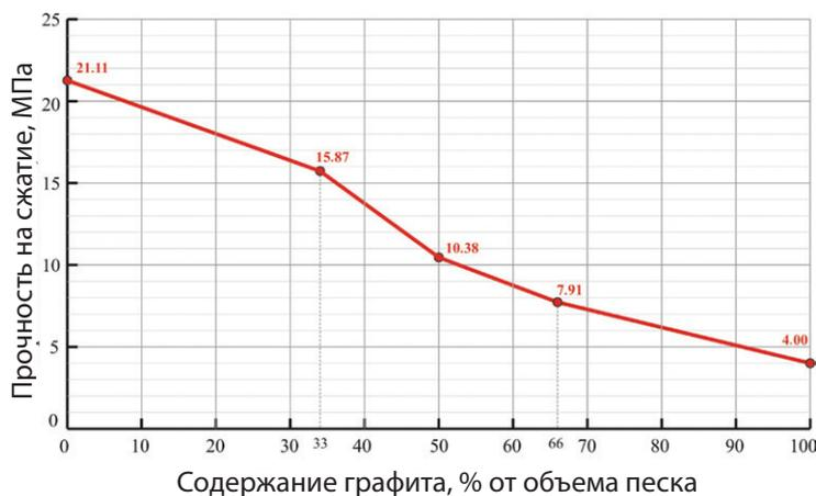
Рис. 3. Результаты испытания опытных бетонных образцов на прочность при сжатии с различным содержанием графита (график составлен авторами)
