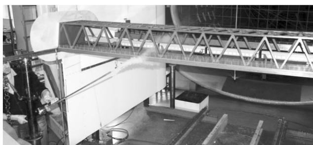
Рис. 3. Испытания модели Крымского моста в аэродинамической трубе<sup>3</sup>
