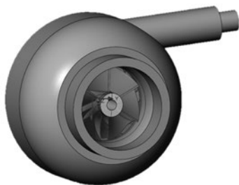
Рис. 2. Упрощенная модель улитки Fig. 2. Simplified scroll model
