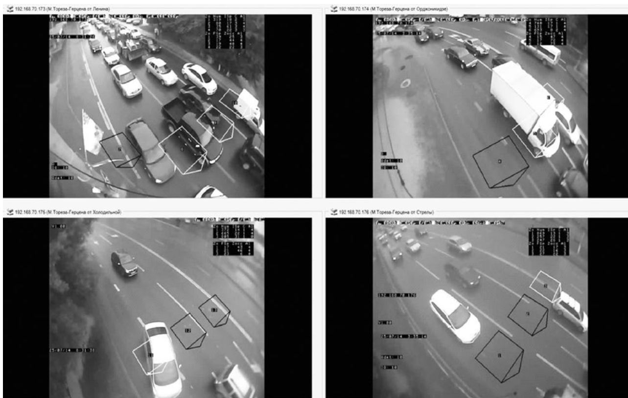
Рис. 1. Мониторинг транспортного потока и фиксация занятости полос движения системой Spectrum 2.0 через видеодетекторы TraffiCam Fig. 1. Traffic flow monitoring and lane occupancy fixation by Spectrum 2.0 via TraffiCam video detectors
